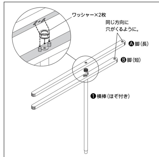
③ ①を④の外側からボルトでしっかりと締め固定します。
