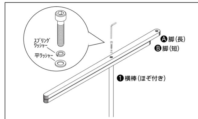
④ 反対側の②と③も同様にボルトで固定します。
