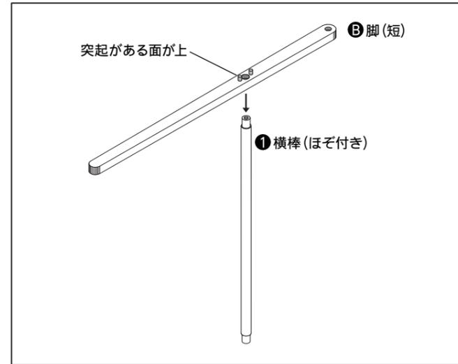
② ①で組んだ、①の先端が②からとび出た部分にワッシャーをはめます。次に②に③を重ねます。このとき、③の溝に②の突起がはまるようにしてください。
