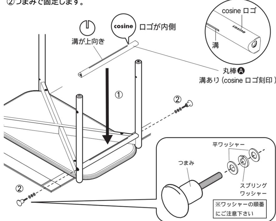
3 ①②で取付け丸棒の溝にマグネットボードを差し込みます。
