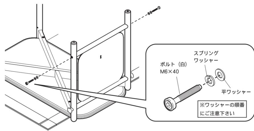
5 残りの丸棒Cも同様の手順で反対側に取付けます。
