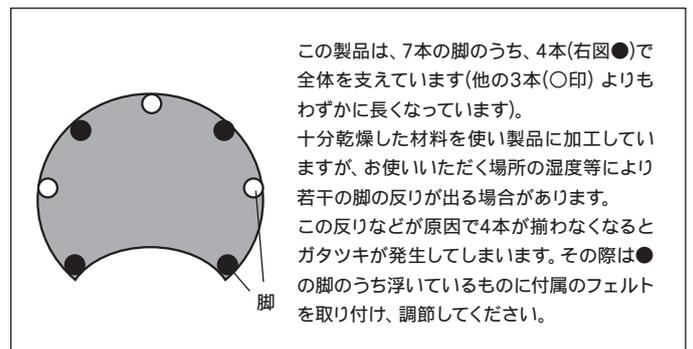
この製品は、7本の脚のうち、4本(右図●)で全体を支えています(他の3本(○印)よりもわずかに長くなっています)。十分乾燥した材料を使い製品に加工していますが、お使いいただく場所の湿度等により若干の脚の反りが出る場合があります。この反りなどが原因で4本が揃わなくなるとガタツキが発生してしまいます。その際は●の脚のうち浮いているものに付属のフェルトを取り付け、調節してください。
